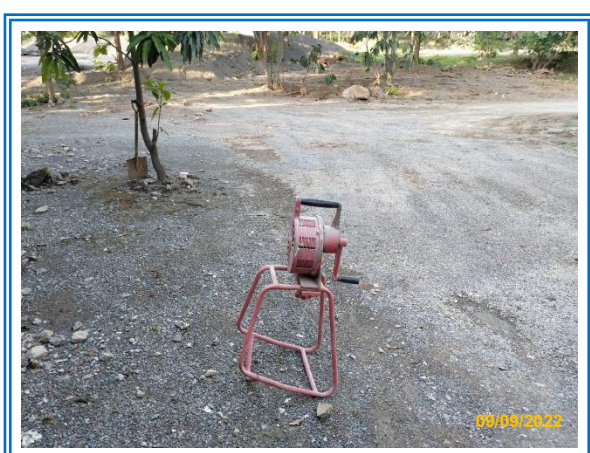
รูปที่ 3-16 เครื่องส่งสัญญาณเตือนก่อนการระเบิด
