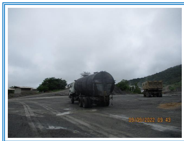
รูปที่ 3-6 การฉีดพรมน้ำ เพื่อลดการฟุ้งกระจาย ของฝุ่นละอองภายในพื้นที่โครงการ
