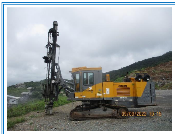
รูปที่ 3-5 เครื่องเจาะระเบิดที่มีอุปกรณ์เก็บฝุ่น ติดไว้กับหัวเจาะ
