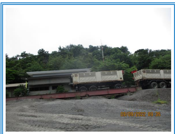
รูปที่ 3-23 จุดซังน้ำหนักรถบรรทุกของโครงการ
